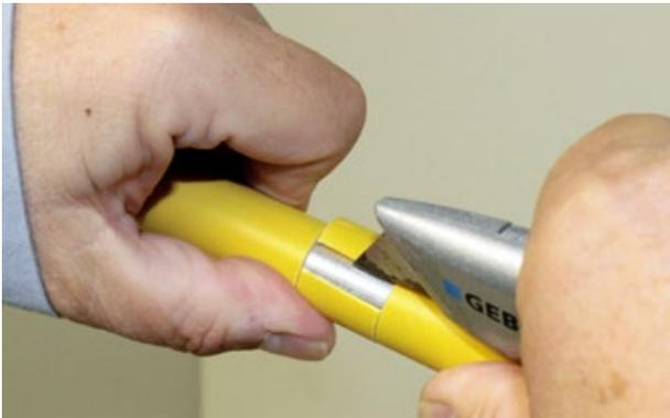
Bild 8: Schlitzen des Kunststoffmantels
