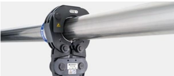
Bild 19: Pressvorgang mit Pressschlinge  $d_a$  42 – 108 mm
