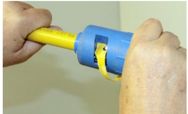
Bild 10: Abmanteln des Kunststoffmantels auf Einschubtiefe
