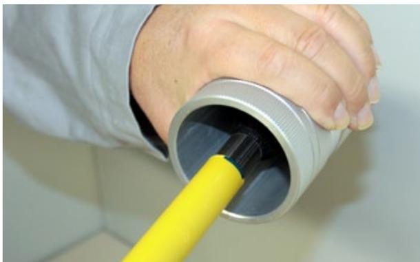
Bild 11: Innenentgraten mit Handentgrater
