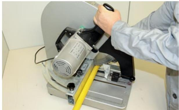
Bild 5: Ablängen mit mechanischer Säge mit Elektromotor
