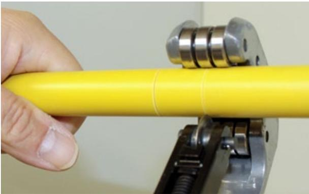
Bild 7: Anritzen des Kunststoffmantels
