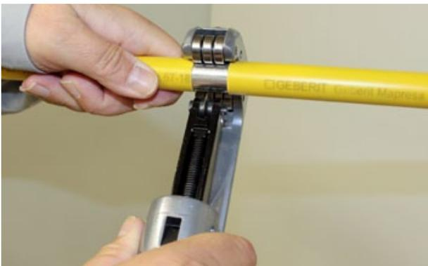
Bild 9: Trennen von Rohr bei entferntem Kunststoffmantel
